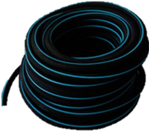
Esta manguera difusora de goma / polietileno patentada de baja presión está hecha para la acuicultura. Este es un tubo eficiente, con una resistencia a la presión de solo 12 "de H2O a caudales normales. Las longitudes de los difusores de hasta 20 'por entrada son posibles a bajas tasas de flujo de aire. Los tubos tienen una buena tasa de transferencia de oxígeno y son compatibles con ambos sistemas regenerativos. Sopladores y bombas de aire lineales.
